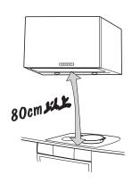
● レンジフード下部には、湯沸器を絶対に取り付けないでください。また、横方向50cm以上離して取り付けてください。湯沸器の真上は高熱になるため故障の原因になります。
