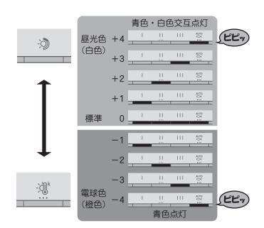
照明スイッチを押し、色温度追従モードの確認 をする
