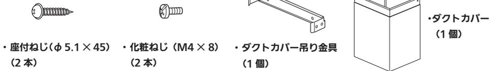
本製品はレンジフードファンの上面に取付け、ダクトジョイント部をカバーするために使用する製品です。取付けに際しては本書およびレンジフードファンに付属の取付説明書をよくお読みになり、正しく取付けを行ってください。
